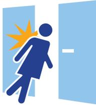
閉じ途中の自動ドアに斜めから進入して、反転した開ききらない自動ドアに衝突する。
